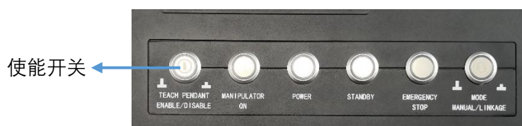
图 7-6 示教器使能开关位置
