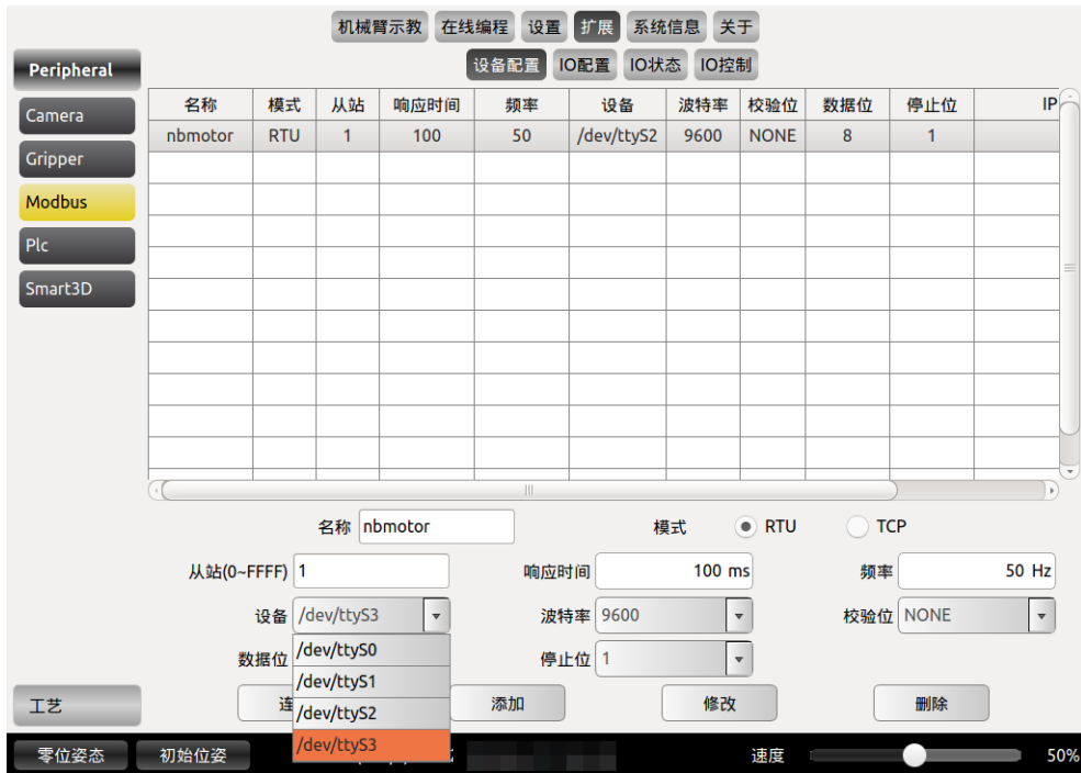
图 10-60 Modbus 设备配置
